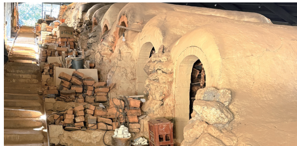
沖縄・やちむんの里「北窯」の登り窯 13段の窯全体を熱するため、焚口で20時間火を焚き続ける
